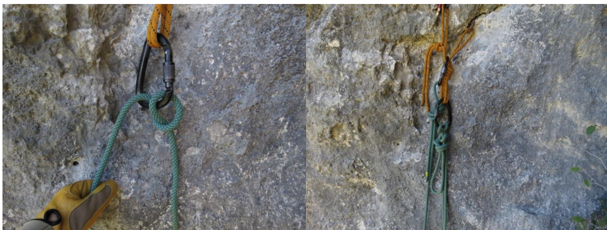
Pravilno vpet pol-bičev vozle. Vrv, s katero reguliramo hitrost, MORA izhajati pri stebelu vponke. Konec vrvi mora biti s končnim vozlom vpet v sidrišče.
